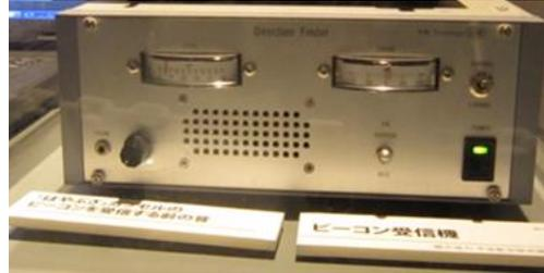
赤マークは石丸さんが製作した LGA。はやぶさ 2 がどんな姿勢になっても必ず地球と交信出来るための重要なアンテナ。右の写真はカプセル落下位置計測用ビーコン受信機、前回のはやぶさ回収時に使用し、今回は再使用。
